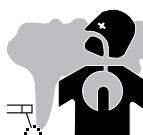
Dampen, gassen en stof die worden uitgestoten tijdens het lassen zijn gevaarlijk voor de gezondheid. Zorg voor voldoende ventilatie, soms is toevoer van verse lucht tijdens het lassen noodzakelijk. Een lashelm met verse luchtaanvoer kan een oplossing zijn als er onvoldoende ventilatie is.
