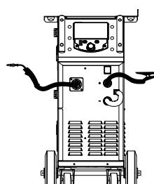
Le soudage MIG/MAG sans protection gazeuse (No Gaz) nécessite généralement une polarité négative.
