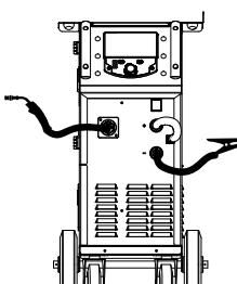
Le soudage MIG/MAG sous protection gazeuse nécessite généralement une polarité positive.
