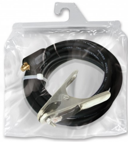
97313 Câble de masse monté T50- 4m-300 A-35mm 2
