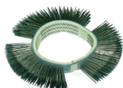
1 条刷带，23 mm，直型，硬化尖端。用于去除油漆、涂层（例如密封剂）和铁锈，无喷砂效果。
