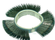
1 courroie-brosse 23 mm, droite, pointe renforcée. Sert à enlever la peinture, les revêtements (par exemple les produits d'étanchéité) et la rouille sans effet de sablage.
