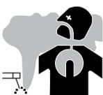
Dampen, gassen en stof die worden uitgestoten tijdens het lassen zijn gevaarlijk voor de gezondheid. Zorg voor voldoende ventilatie, soms is toevoer van verse lucht tijdens het lassen noodzakelijk. Een lashelm met verse luchtaanvoer kan een oplossing zijn als er onvoldoende ventilatie is.
