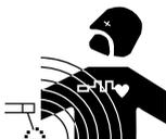
Elektrische stroom die door geleidend materiaal of kabels gaat veroorzaakt plaatselijk elektrische en magnetische velden (EMF). De lasstroom wekt een elektromagnetisch veld op rondom de laszone en het lasmateriaal.
