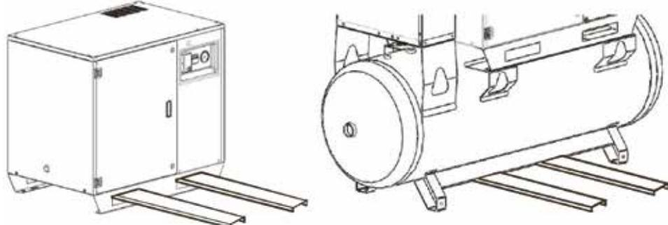
De compressor zonder luchttank moet worden opgetild met een transpallet of een vrachtwagen met voldoende capaciteit. Op dezelfde manier moet de compressor met luchttank (zie fig. 9) worden opgetild. Het gewicht staat in hoofdstuk 3.2 Technische kenmerken.
