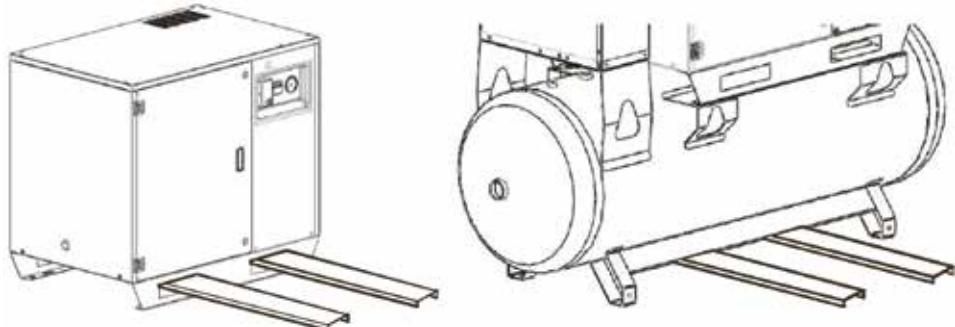
Le compresseur sans réservoir d'air doit être soulevé à l'aide d'un transpalette ou d'un camion de capacité appropriée. Le compresseur avec réservoir d'air (voir fig. 9) doit être soulevé de la même manière. Le poids est indiqué dans la section 3.2 Caractéristiques techniques.
